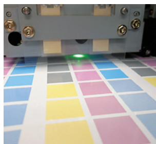
RGBセンサーが調整パターンから適正値を自動で読み取ります。
